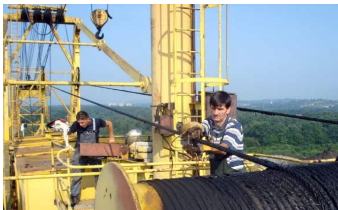
Terensko ispitivanje čelične užadi magnetno-indukcionim aparatom / On site testing of steel ropes with magnetic-induction apparatus
